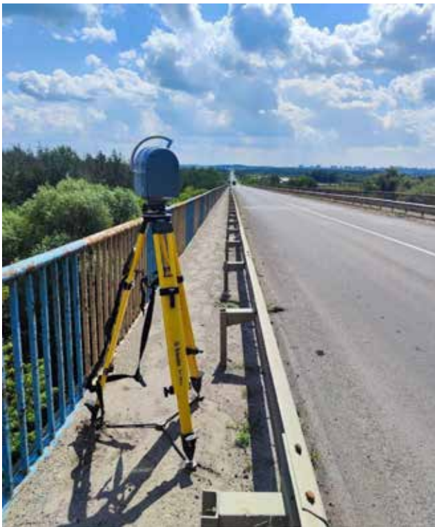
Рис. 6. Загальний вигляд сканера Trimble TX6 встановленого на станції стояння
